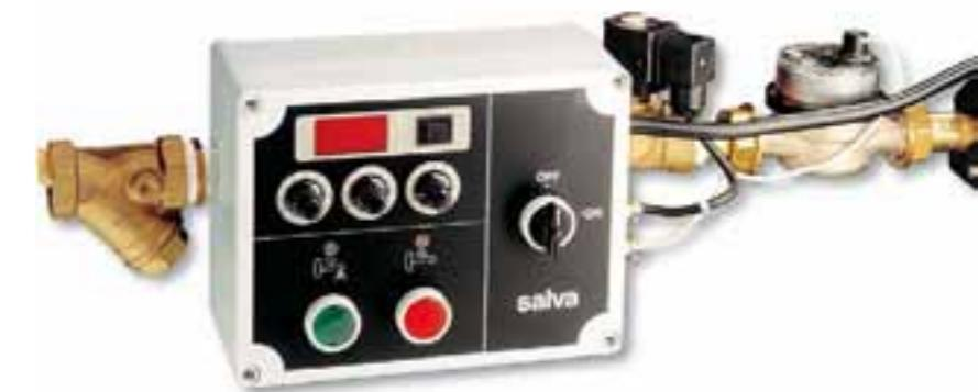
Dotado de selector electrónico de 3 dígitos con memoria "Last Program", repite la última cantidad marcada con solo apretar un botón. La valvula de paso con filtro de impurezas evita las obstrucciones del dispositivo, y es capaz de trabajar a una presión de hasta 10 atmosferas.
