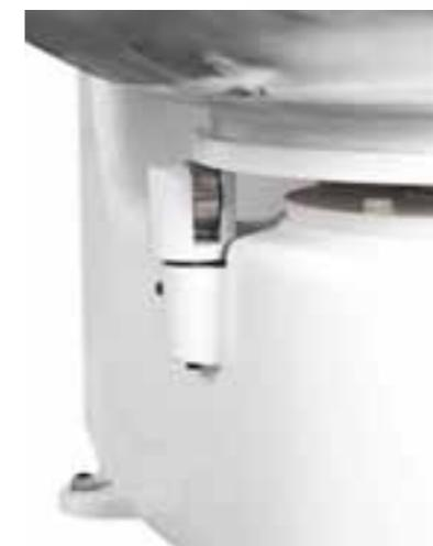
La artesa con rodamiento de apoyo lateral elimina los balanceos, aumentando la vida de la maquina y sus componentes.
