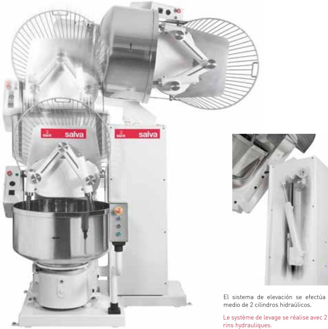
El sistema de elevación se efectúa por medio de 2 cilindros hidráulicos.
