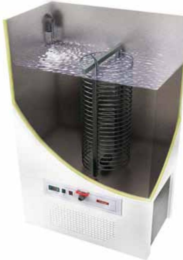
Esta equipado con control electrónico y agitador, con el fin de conseguir una temperatura exacta y homogénea del agua. La construcción de la cuba en acero AISI 304 le otorga la maxima protección contra la corrosión. Aislado con paneles tipo sandwich de poliuretano inyectado, que minimizan las perdidas energéticas. Es capaz de disminuir la temperatura de 175 litros de agua a razón de 5º/hora con un consumo de tan solo 0,45 kW.
