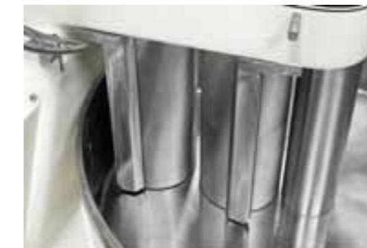
Los cilindros refinadores SALVA-SAUS son la herramienta perfecta para el refinado de masas de todo tipo. Equipado con 2 rodillos de acero inoxidable alimentario que expulsan el oxígeno retenido en la estructura de la mezcla. Construido con materiales de gran calidad: chasis de alta rigidez en acero y cuba en AISI 304. Máxima fiabilidad gracias a su sistema de transmisión por engranajes en baño continuo de aceite.
